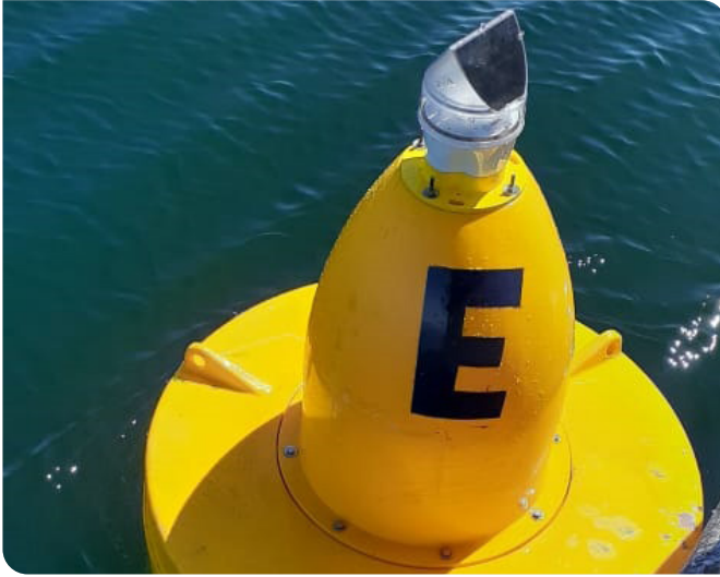
Linterna Sealite SL-75 (mostrada en la boya SL-B1250 Buoy) puede ser programada remotamente a través del Bluetooth por conveniencia y seguridad.
