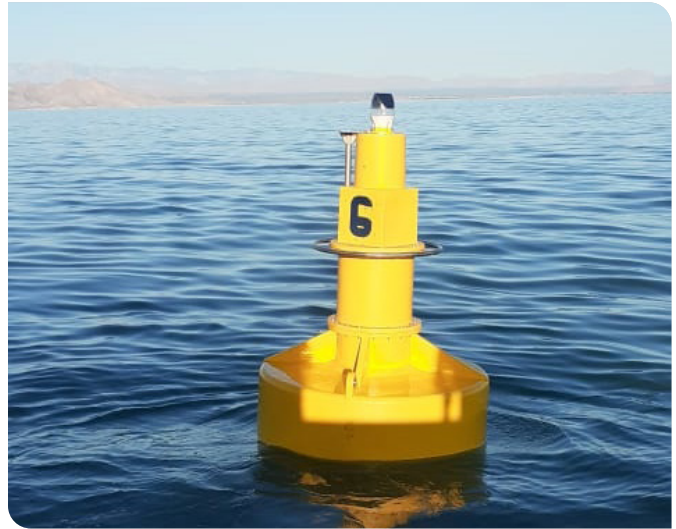
Todas as lanternas marítimas com GPS habilitado para SL-75 podem piscar em uníssono gerando uma visibilidade excepcional à noite ou com condições climáticas ruins
